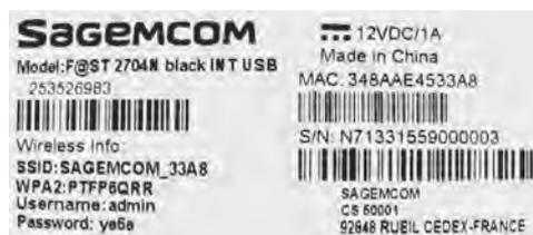
Avec le modem correspondant à l'étiquette ci-haut, le nom de réseau sans fil (SSID) serait SAGEMCOM\_33A8 et la clé de chiffrement (WPA) pour se connecter à ce réseau sans fil serait PTFP6QRR.
